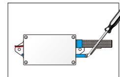
5. 拨正电源压片，接着用螺丝刀把固定电源压片的螺丝拧紧。
