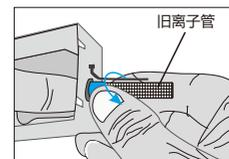
3. 逆时针扭动离子管数圈，离子管即可取出。
