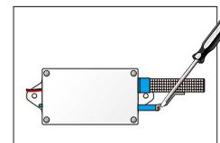
2. 用螺丝刀把固定电源压片的螺丝扭开，拨开电源压片。
