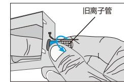
3.逆时针扭动离子管数圈，离子管即可取出。
