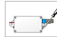
5.拔正电源压片，接着用螺丝刀把固定电源压片的螺丝拧紧。
